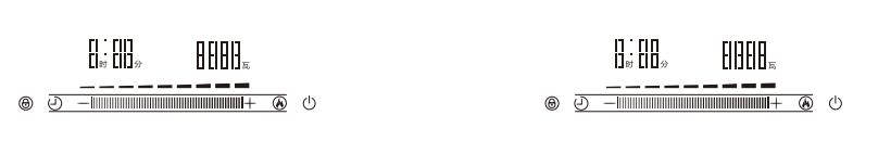
电磁灶上电后,蜂鸣器鸣叫一声,数码管或者指示灯显示相应状态(----或电源灯闪烁)。
